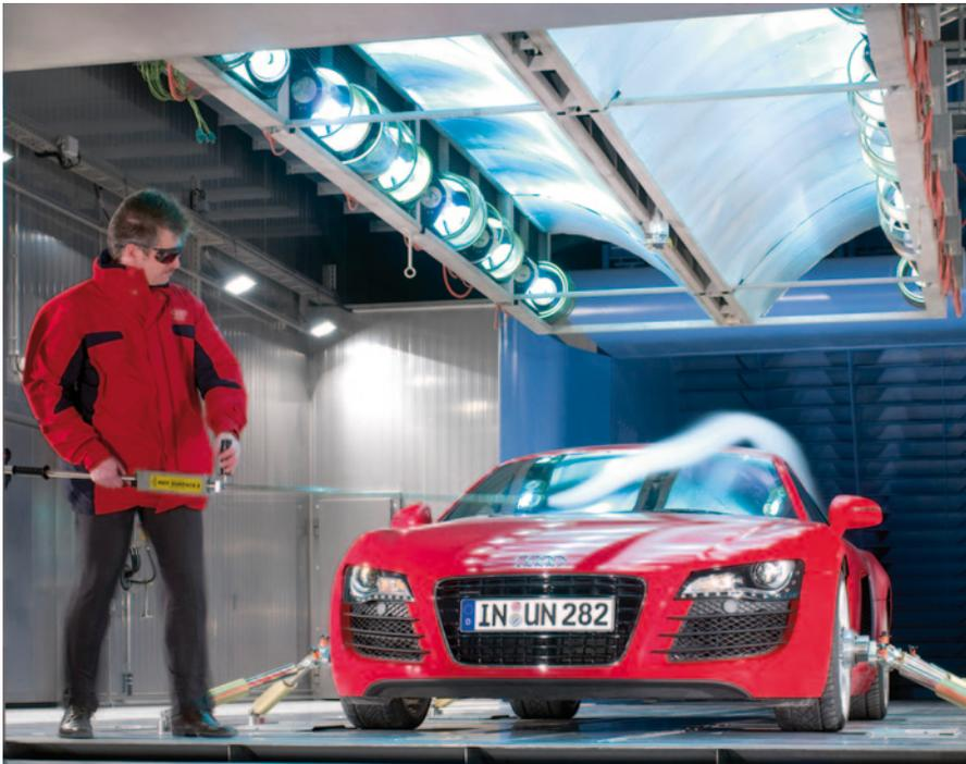
**Abb. 11.1** Klimawindkanal der Audi AG (Bj. 2007); Messstrecke mit Sonnenstrahlungssimulator. (Quelle: Audi AG)
