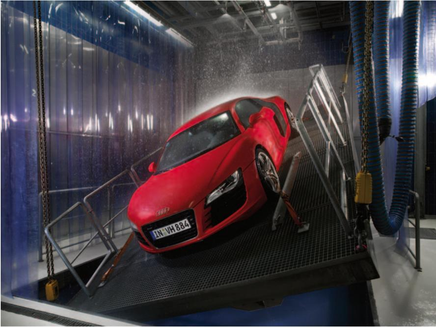
**Abb. 11.12** Beregnungsanlage und schwenkbare Hebebühne. (Quelle: Audi AG)
