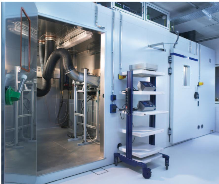
**Abb. 11.9** Außenansicht des Prüfstands zur Messung kompletter Kältemittelkreisläufe und einzelner Komponenten. Prüfstand mit 2 Kammern. (Quelle: Audi AG)
