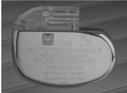
**Abb. 23.** ITREL: erster implantierbarer neurologischer Impulsgenerator (Mitte der 1980er Jahre).
