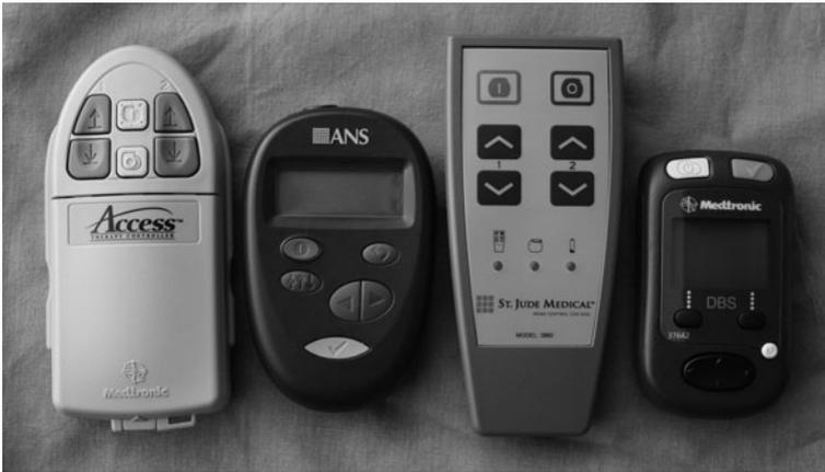
**Abb. 19.** Patientensteuergeräte gibt es in unterschiedlichen Ausführungen jeweils passend zu einem bestimmten Impulsgebertyp. Diese Geräte erlauben es den Patienten, die Batterie (Akku) des Impulsgebers zu überprüfen und, in einem vom Arzt vorgegeben Bereich, die Stimulationswerte zu verändern und gegebenenfalls anzupassen. Die Stimulation kann damit auch ein- und ausgeschaltet werden.
